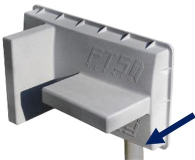
Die Spitze der Antenne zeigt zum Sendemast!
